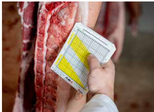
Messung Muskelfleischanteil mittels Messkarte
