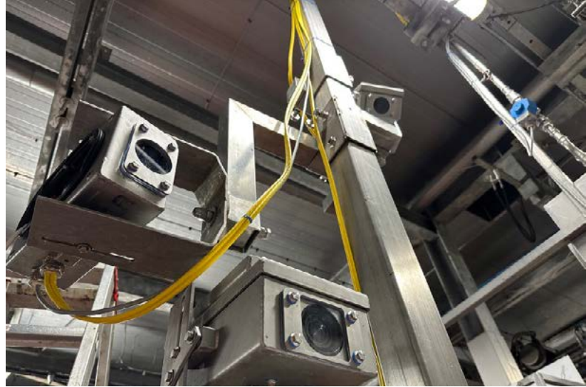
Kameras zur Erfassung von Tierschutzindikatoren und Fotodokumentation.
